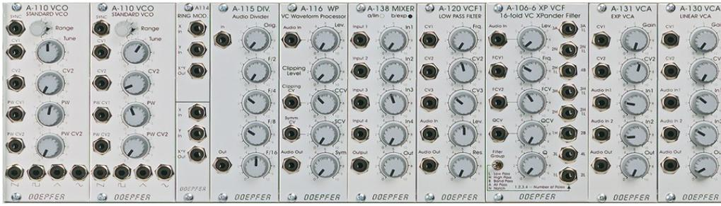
Abbildung 2: Eine Zeile des Doepfer A100 Modularsystems mit unterschiedlichen signalverarbeitenden Modulen
