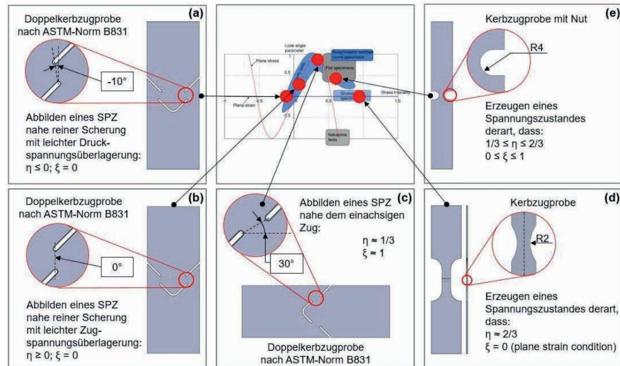
Ausgewählte Schädigungsproben und jeweilige Spannungszustände. © LWF
