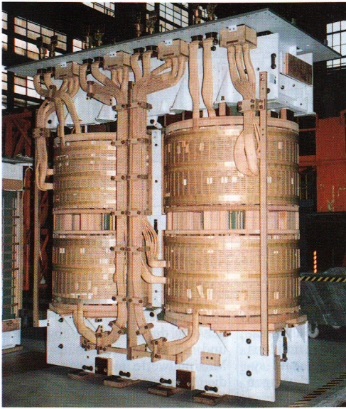
Bild 6: Aktivteil des einphasigen 20-MVA-Bahntransformators.
